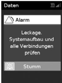
Wird ein Alarm ausgelöst, blinkt die gelbe LED-Alarmanzeige, der Alarm ertönt und eine Meldung erscheint auf dem Bildschirm.
